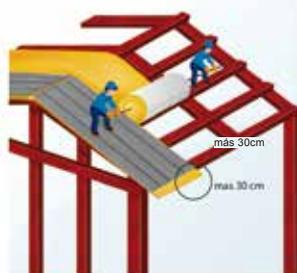
2- Desenrollar. Esta operación debe realizarse dando una ligera tensión al material (no excesiva, para evitar que la película se rasgue o deforme), con el objeto de que la superficie quede prácticamente plana.
