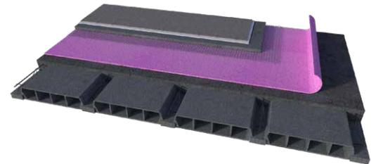
Aislamiento para sonido por impacto en sistema de vigueta y bovedilla y/o sistema de concreto.
