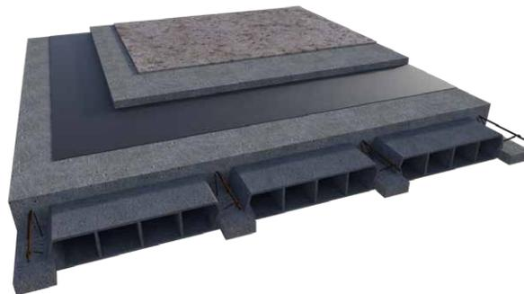
Aislamiento para sonido por impacto en sistema vigueta y bovedilla y/o sistema de concreto
