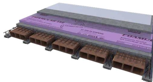
Aislamiento térmico en sistema de vigueta y bovedilla.
