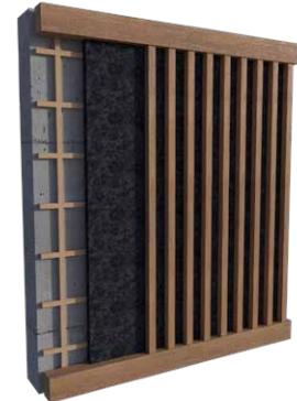
Sistema forrado para muros de mampostería con diseño en celosía
