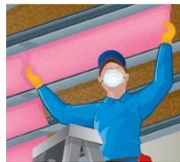
9.- Si la unidad eléctrica tiene las letras IC, puede instalar el aislamiento en contacto con el equipo de iluminación. De otro modo, coloque el aislamiento a una distancia de 7.6 cm del equipo.
