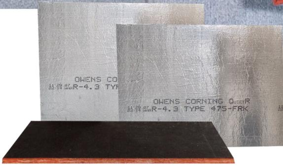
QuietR® Duct Board™ es una placa rígida de fibra de vidrio con un recubrimiento de FSK por fuera y un velo al interior. El FSK es resistente al fuego y a esfuerzos mecánicos. El velo ofrece una superficie durable y resistente al flujo de aire; además de proteger a la fibra de vidrio del polvo y suciedad. El sistema del ducto armado queda aislado con excelentes propiedades térmicas y acústicas.
